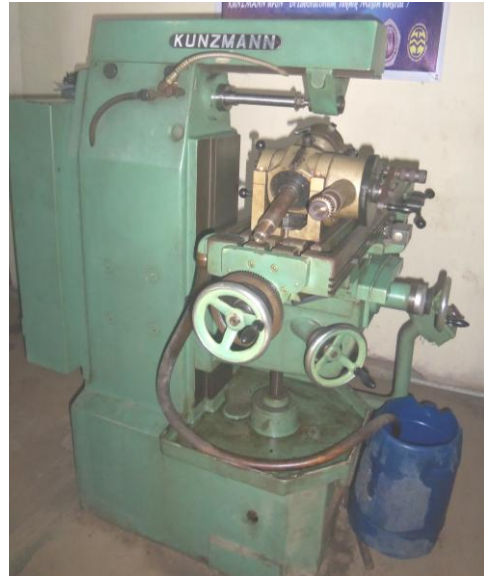
Gambar 3.1 Mesin Frais Horizontal Kunzmann UF6N
