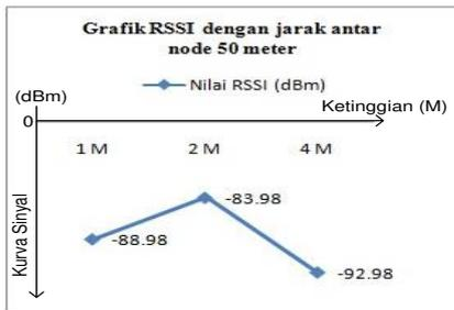
Gambar 4.7 Grafik pengujian *outdoor* dengan jarak 50m
