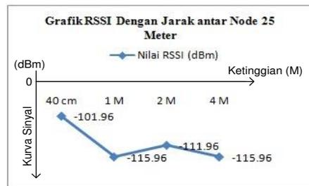
Gambar 4.2 Grafik pengujian indoor dengan jarak 25 m
