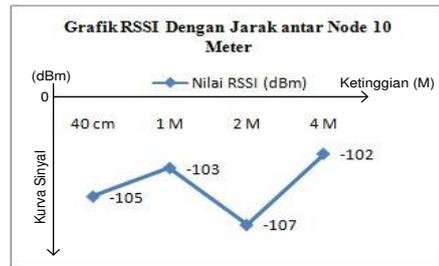
Gambar 4.1 Grafik pengujian indoor dengan jarak 10m
