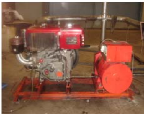
Gambar-1. Motor diesel pada pengujian Tabel-2 memberikan spesifikasi motor diesel yang dikopel dengan generator listrik sebagai beban.
