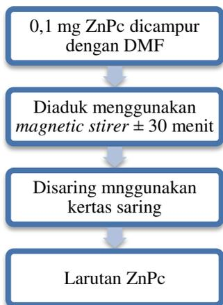
**Gambar 2.** Skema kerja pembuatan larutan ZnPc
