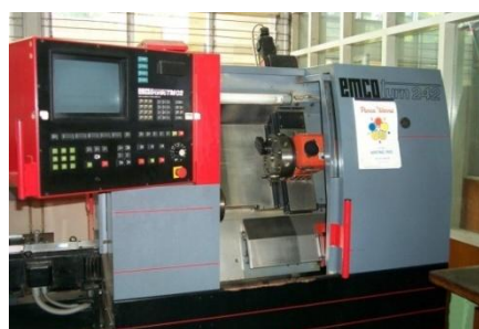
Gambar. 2 Mesin Bubut CNC 2 sumbu EMCO ET242
