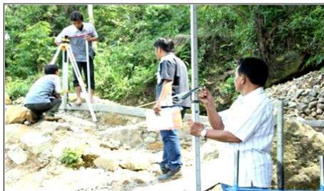
Gambar 2 Pengukuran ketinggian jatuh air sungai Ciasihan
