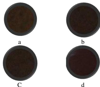
Gambar 2. Pengaruh temperatur kalsinasi terhadap perubahan warna serbuk  $BaFe_{12-x}Ni_xO_{19}$  pada konsentrasi dopan yang sama (a)  $80^\circ\text{C}$  (b)  $400^\circ\text{C}$  (c)  $600^\circ\text{C}$  (d)  $800^\circ\text{C}$
