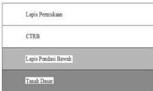
Gambar 3. Struktur Perkerasan dengan CTRB
