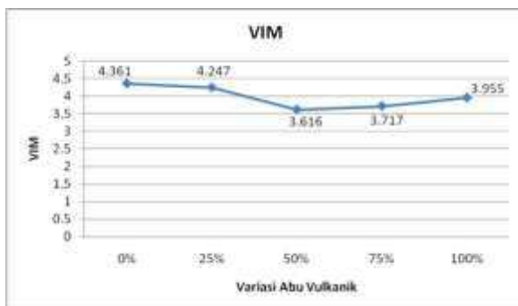
Gambar 11 Hasil Pengujian Pengaruh Kadar Abu Vulkanik Terhadap Nilai Void in the mix (VIM) Campuran AC-WC
