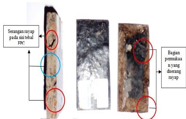
Gambar 8. FPC 70:30 1% setelah pengujian rayap (di dalam lingkaran merah)
