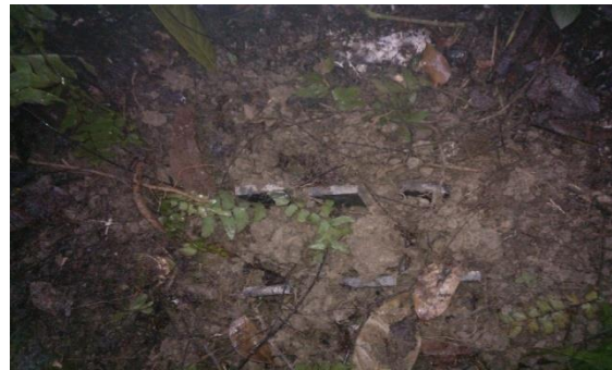
Gambar 1. Penanaman Contoh Uji FPC Pada Areal Uji Grave Yard Test
