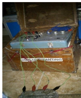
Gambar. 5. Pengambilan sampel lumpur menggunakan peralatan geolistrik dengan konfigurasi Wenner
