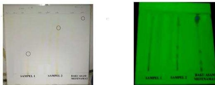
**Gambar 2.** Hasil kromatografi lapis tipis dengan eluen kloroform : metanol diamati pada sinar tampak (kiri) dan sinar UV 254 nm (kanan).
