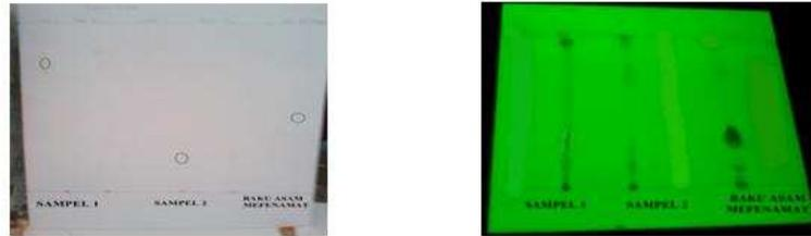
**Gambar 3.** Hasil kromatografi lapis tipis dengan etil asetat : metanol : ammonia diamati pada sinar tampak (kiri) dan sinar UV 254 nm (kanan).
