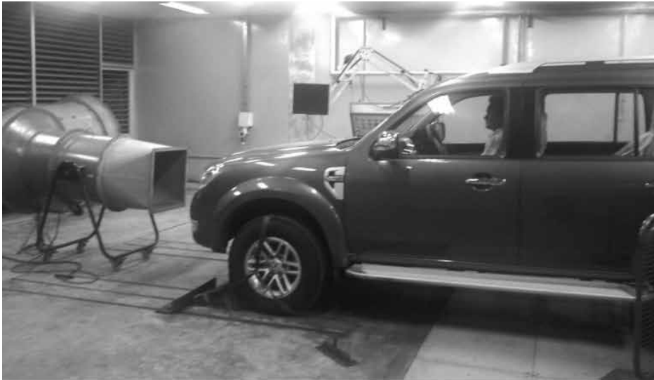
Gambar 1. Pengujian kendaraan dengan chasis dynamometer.
