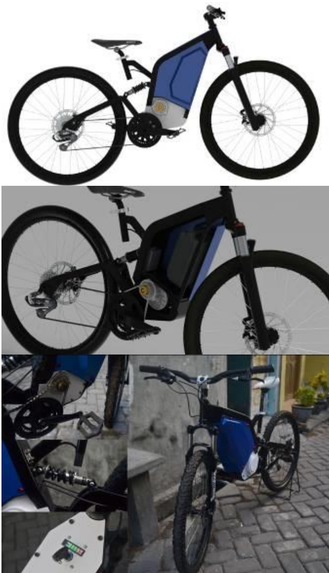
Gambar 6. Rendering dan prototip final desain sepeda listrik untuk remaja SMP dan SMA
