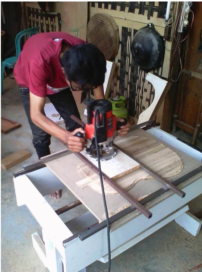
Gambar 6. Proses penipisan soundboard laminasi rotan (sumber:penulis)
