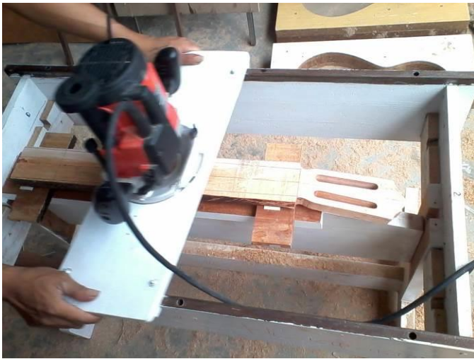
Gambar 5. Proses pembuatan neck (sumber:penulis)
