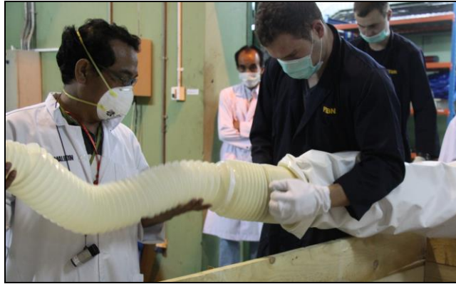
Gambar 3. Pemasangan booting pada slave arm unit
