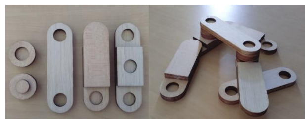
Gambar 2 Studi Model bentuk modul playground dengan menggunakan kayu balsa berskala 1:5.
