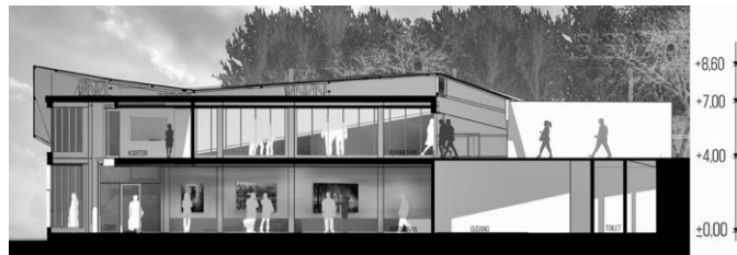
Gambar 12 . Potongan Bangunan Utama
