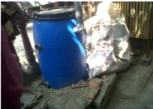
Gambar 4. Pengolahan limbah organik rumah tangga dengan dekomposter aerob.
