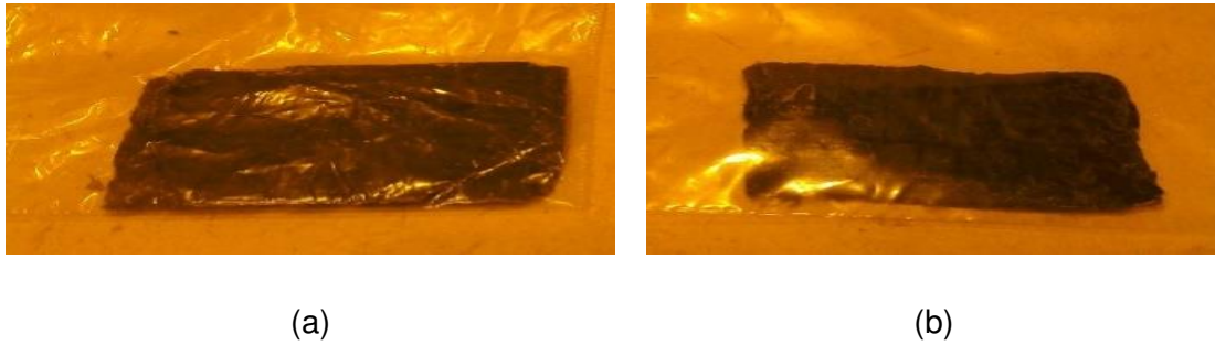
Gambar 2. KMK SiC yang diperoleh dari teknik PIP, (a) KMK-P dan (b) KMK-PS.
