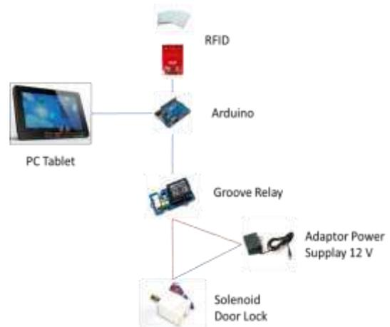
Gambar 7. Skema peralatan kontrol pintu putar
