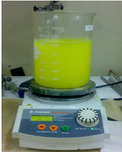
Gambar-2. Proses re-ekstraksi pemisahan fase
