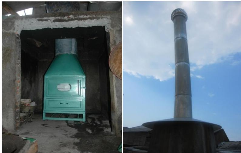
Gambar 3. Oven pangnan, cerobong dan turbin ventilator hasil IbM
