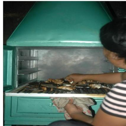
Gambar 5. Proses pemanggangan ikan menggunakan oven
