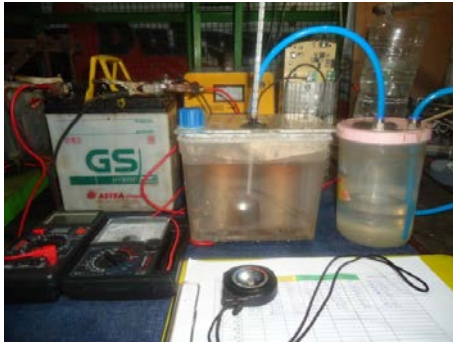
Gambar. 7. Rangkaian uji laju produksi gas HHO.
