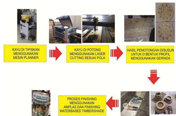
Gambar. 2. Bagan proses produksi
