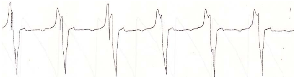
Gambar 20. Output Blok Rangkaian Pemisah Sinkronisasi Pada Saat Saklar diputuskan ( 8 V pp )
