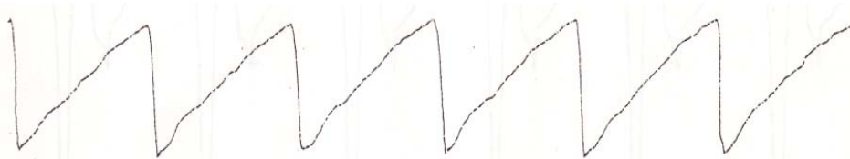
Gambar 23. Output Blok Rangkaian Horizontal Oscilator ( 5 V_{pp} )
