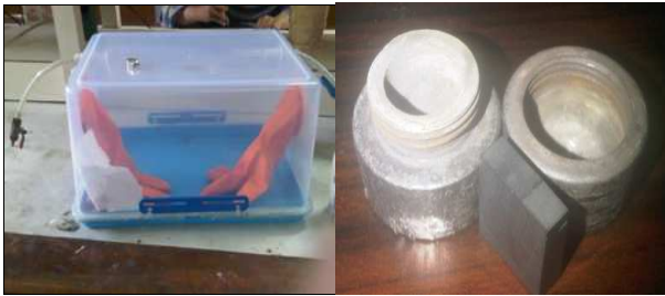
Gambar 1. Gloves Box (kiri) dan Tabung Reaktor (kanan)
