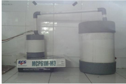
Gambar 1. (a) Digester biogas dan (b) penampung gas CH 4
