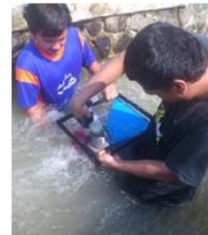
Gambar. 4. Pengukuran RPM turbin menggunakan tachometer digital.
