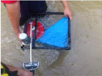
Gambar. 5. Pengukuran torsi turbin menggunakan torsimeter static.
