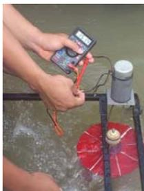
Gambar. 6. Pengukuran tegangan dan arus dari Generator DC.
