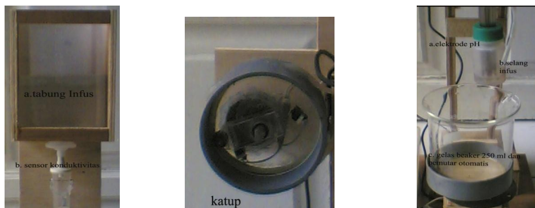
Gambar 5 .a) Rangkaian titran, b) Rangkaian katup, dan c) Rangkaian titer .
