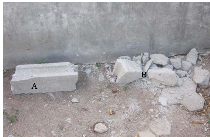
Gambar 4. Uji Jatuh Batako, (A) Batako Menggunakan Abu Terbang Batubara; (B) Batako Tanpa Abu Terbang Batubara
