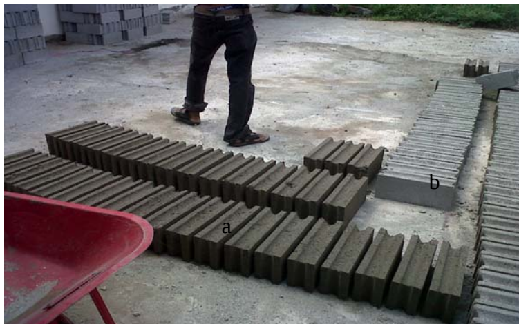
Gamabar 3. a. Batako baru dicetak dan b. Batako yang sudah berumur 7 hari
