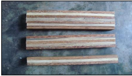
Gambar 1. Susunan Lapisan Balok Laminasi
