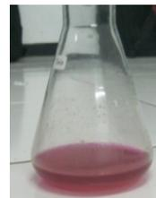
Gambar. 1. Pengukuran FFA dengan titrasi.
