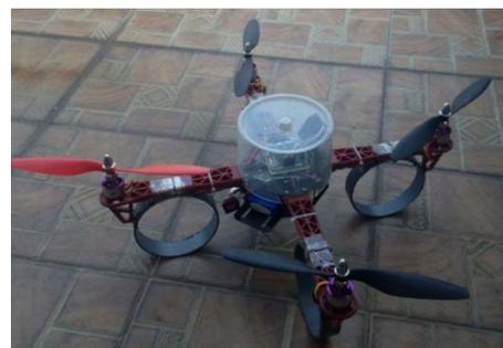
Gambar. 3. Hasil Desain Mekanik Quadcopter
