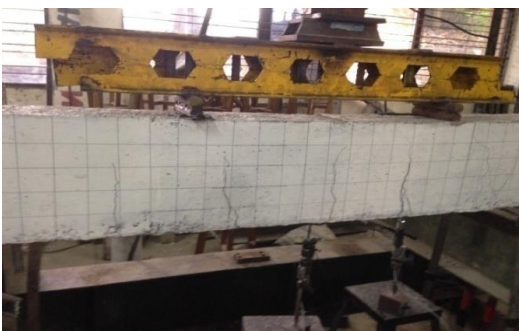
Gambar 10. Pola keruntuhan balok beton bertulang bambu 5D12
