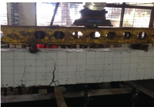
Gambar 9. Pola keruntuhan balok beton bertulang bambu 4D12
