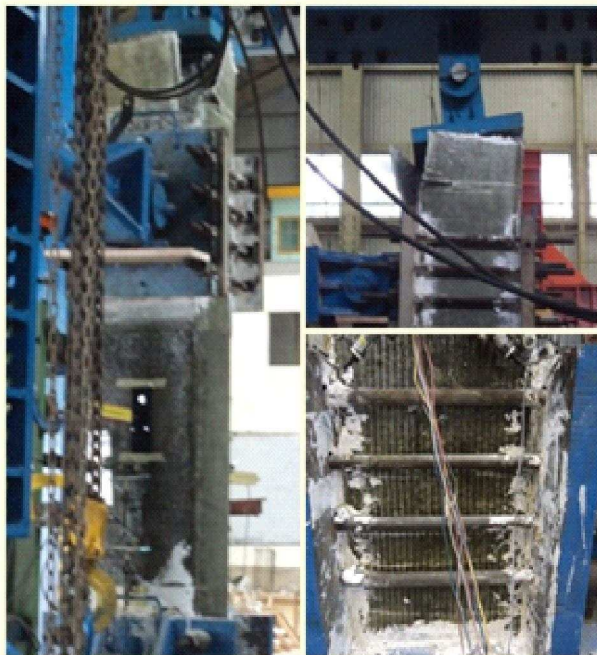
Gambar 4. Kegagalan benda uji C-1G
