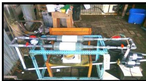
Gambar. 3. Pengujian membran dalam reaktor cross flow
