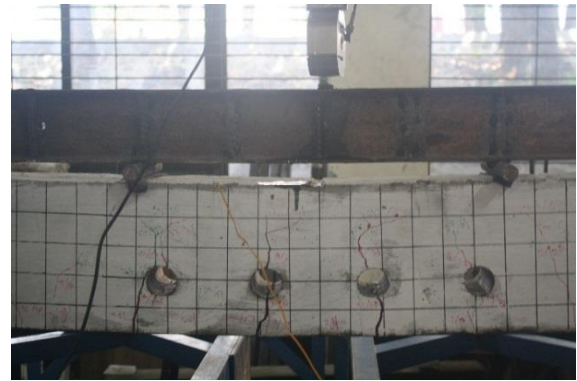
Gambar 12. Pola Retak pada Balok dengan Empat Bukaan (BB4)
