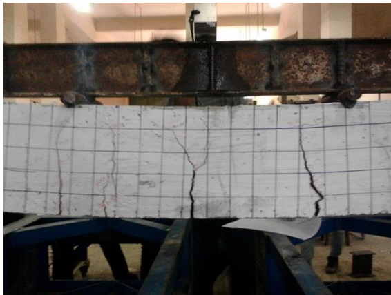
Gambar 10. Pola Retak pada Balok Kontrol (BK)
