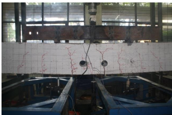
Gambar 11. Pola Retak pada Balok dengan Dua Bukaan (BB2)
