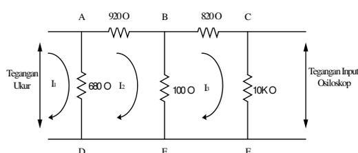
Gambar 7. Rangkaian pembagi tegangan
