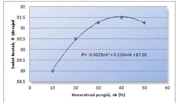
Gambar 8 Grafik hubungan sudut kontak dan konsentrasi pengisi komposit resin epoksi
