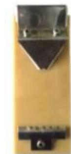
Gambar 5. Penempatan elektroda pada bahan uji
