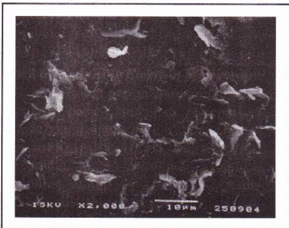
Gambar 7. SEM LDPE/tapioka 80/20 MAH 4 phr sesudah pemendaman dalam tanah perbesaran 1000 x
