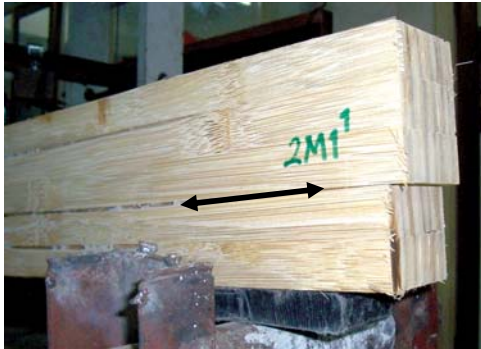
Gambar 6. Kerusakan sepanjang garis perekatan balok laminasi
