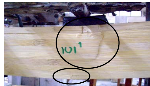
Gambar 5. Pola kerusakan balok tepat pada titik beban
