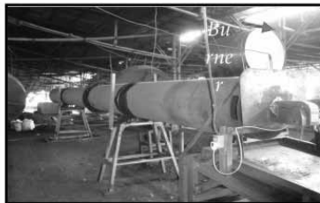
Gambar 3. Proses Pengeringan POG Menggunakan Rotary Drayer
