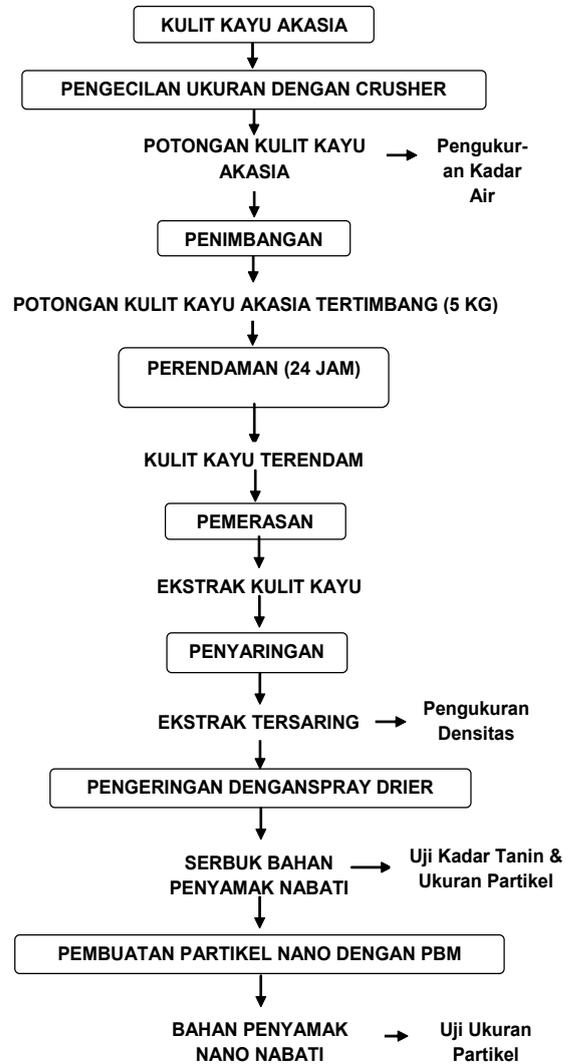
**Gambar 1.** Diagram proses pembuatan bahan penyamak nano nabati.
