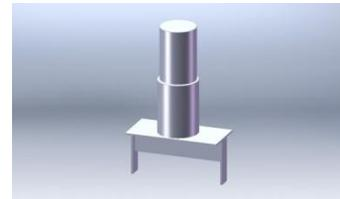
Gambar 1. Bentuk punch untuk proses penekanan
