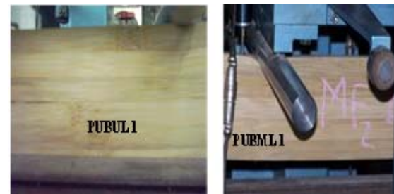
Gambar 9. Kerusakan balok bilah dengan perekat melamine formadehyde dan urea formaldehyde uji lentur keruntuhan lentur.
