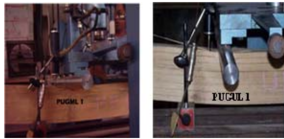
Gambar 8. Kerusakan balok galar dengan perekat melamine formadehyde dan urea formaldehyde uji lentur keruntuhan lentur.
