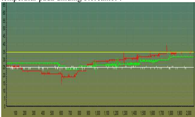
Gambar. 15. Grafik Respon Gangguan Pada Dinding Berpemanas (menggunakan heater ).
