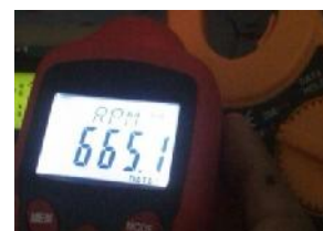
Gambar 4.7. RPM motor dengan PWM duty cycle 25%
