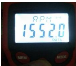
Gambar 4.10. RPM motor dengan PWM duty cycle 100%
