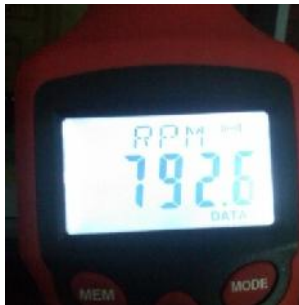
Gambar 4.8. RPM motor dengan PWM duty cycle 50%
