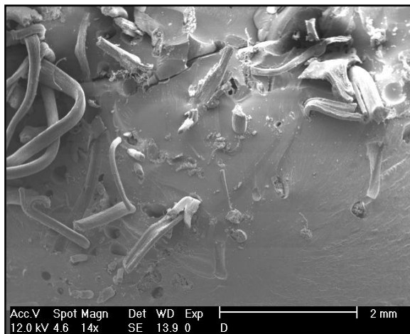
Gambar 6. Mekanisme Pull-out pada Specimen Bending
