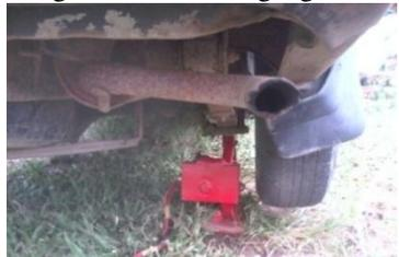
Gambar 13. Dongkrak telah mengangkat mobil gran max
