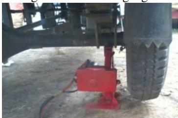
Gambar 15. Dongkrak belum mengangkat motor 3 rod
