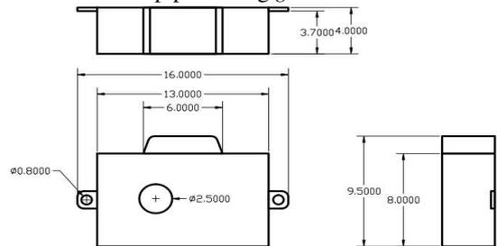
Gambar 5. Desain tutup pelindung *gearbox*
