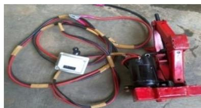
Gambar 9. Dongkrak ulir elektrik, saklar dan kabel
