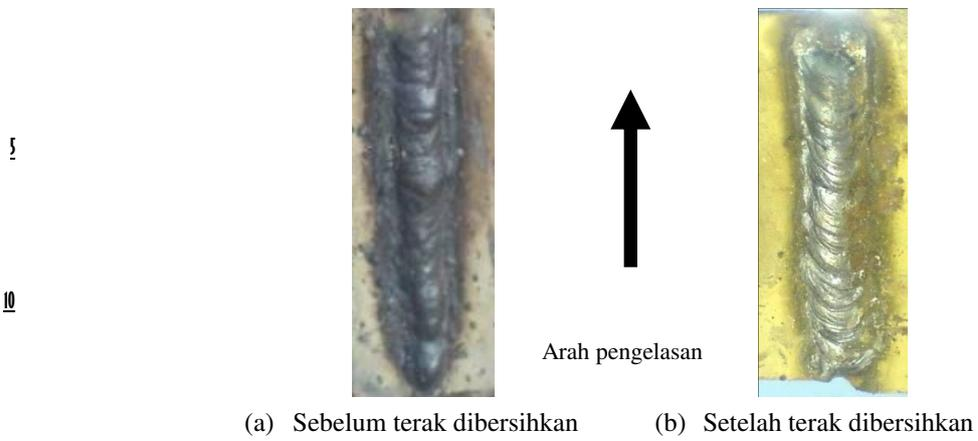
Gambar 5. Hasil pengelasan *vertical position*.
